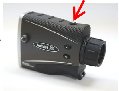
③表示が切り替わるので、次に[▼]ボタンを何回か押し、[HACAL]を表示されたら、器械上部の[Fire]ボタンを押す。
