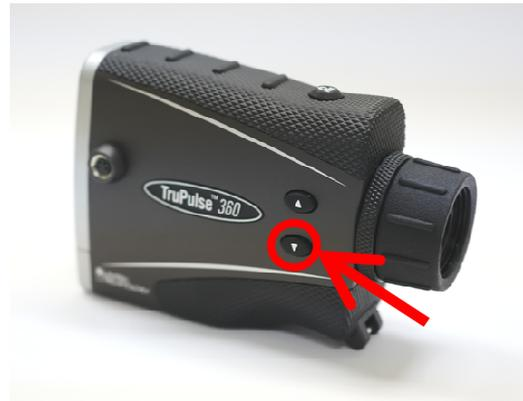
②[▼]ボタンを何回か押し、[H\_Ang]を表示し、器械上部の[Fire]ボタンを押す。
