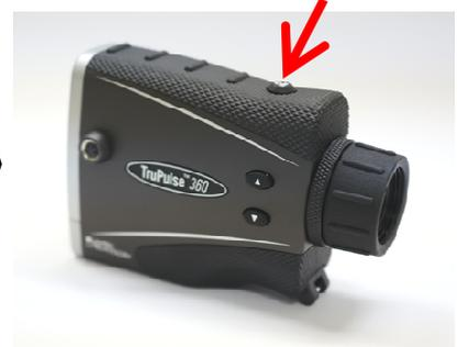
④モニターが表示が[no HACAL]と[yes HACAL]と交互に表示が切り替わるので、[▼]ボタンで[yes HACAL]にし、器械上部の[Fire]ボタンを押す。
